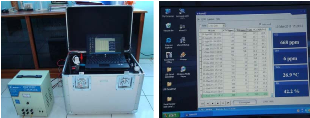
Gambar 7. Infrared Gas Analyzer (IrGA) dan contoh hasil alisis gas \text{CO}_2 dan \text{CH}_4
